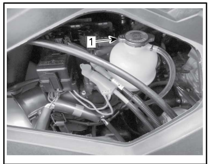
1. Verschluss des Expansionsgefäßes
