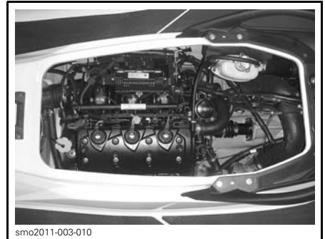
COMPARTIMENT MOTEUR, SIÈGE ENLEVÉ
