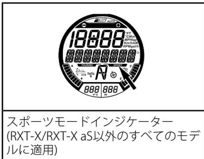
スポーツモードインジケータ (RXT-X/RXT-X aS以外のすべてのモデルに適用)
