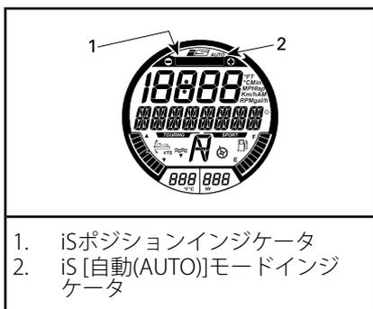
サスペンションシステムが[自動(AUTO)]モードで動作している場合、[自動(AUTO)]インジケータとポジションインジケータのすべてのバー部分が点灯します。
