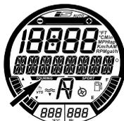
ツーリングモードインジケーター (RXT-X/RXT-X aS以外のすべてのモデルに適用)
