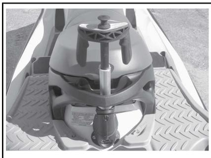
引き出されたスキー/ウエイクボードポストを格納するには、ポストの上をまっすぐ下へ押しします。ポストの引き出しや格納がうまくいかないときは、ロックングクリップの両側を同時にウォータークラフトの前方方向へ押しします。
