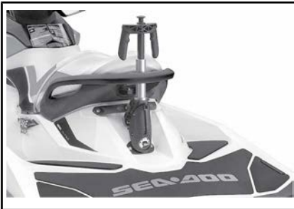
TÍPICA - MASTRO PARA ESQUI/WAKEBOARD ESTENDIDO
