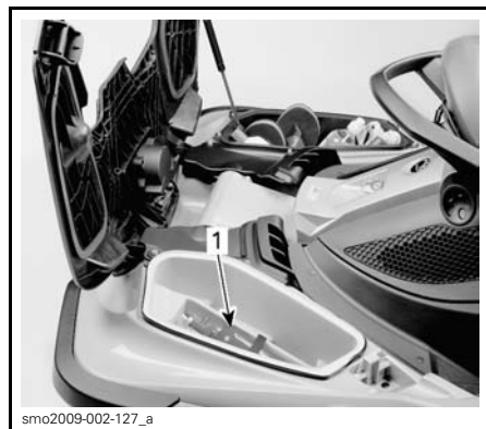
1. Placering av hållare för brandsläckare
