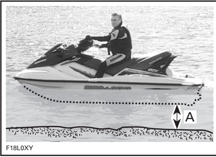
A. Er moet minstens 90 cm water onder het laagste punt van de romp zijn als alle passagiers aan boord zijn
