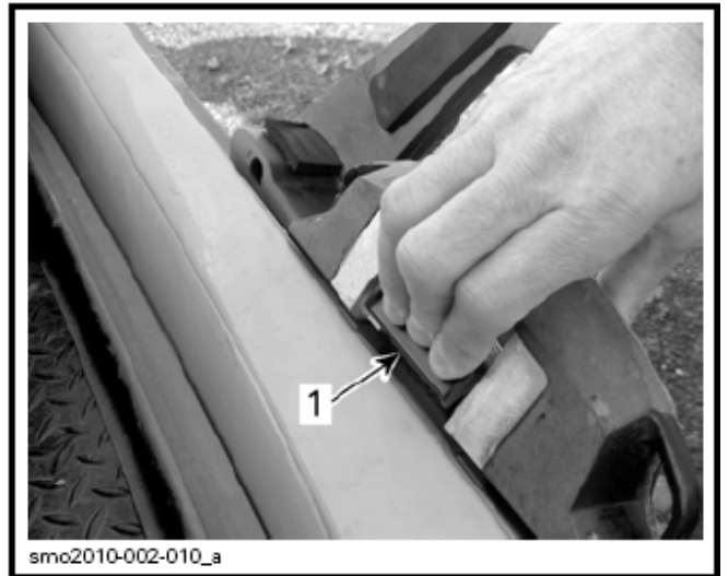
尾波板架拆卸
