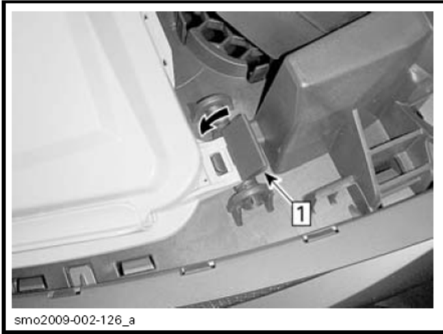
步骤 1: 向下推入锁扣来固定
