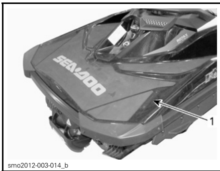
TÍPICA 1. Número de identificação do casco (HIN)
