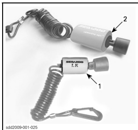
TÍPICA - CORDÕES DE SEGURANÇA 1. Chave Aprendizado, boia verde 2. Chave normal, boia amarela ou preta
