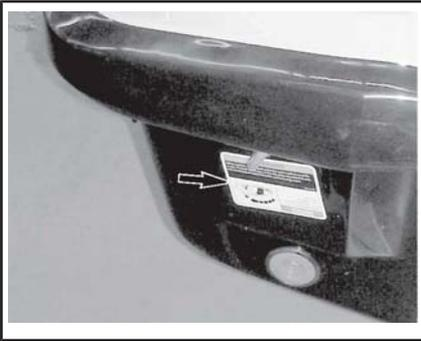
Il motore 4-TEC™ è dotato di un sistema di protezione in caso di ribaltamento (T.O.P.S.™). Quando l'imbarcazione si ribalta, il motore si spegne automaticamente.
