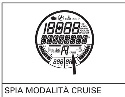
Un messaggio scorrerà sul display multifunzione per segnalare che si sta ora viaggiando in modalità bassa velocità. Sul display numerico si visualizzerà inoltre per pochi secondi l'impostazione di default di bassa velocità uguale a 1.
