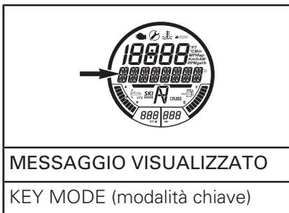
4. Premere il pulsante SET una volta per attivare la funzione di impostazione della modalità Learning key. Sul display appare L-Key.
