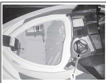
*CONFIGURAZIONE TIPICA - POSIZIONE DEL TAPPO SERBATOIO CARBURANTE*
