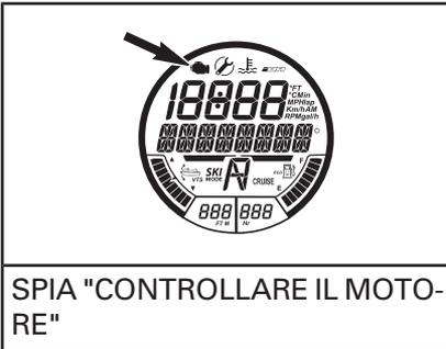
SPIA "CONTROLLARE IL MOTORE"
