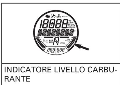
Quando il serbatoio è pieno sono accese 8 barre dell'indicatore. Il segmento superiore non è utilizzato.
