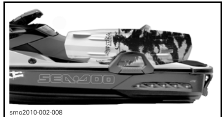
TYPIQUE - PLANCHE INSTALLÉE ET DÉRIVES ORIENTÉES VERS L'EXTÉRIEUR
