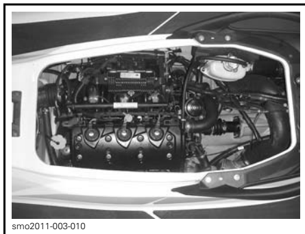
COMPARTIMENT MOTEUR, SIÈGE ENLEVÉ
