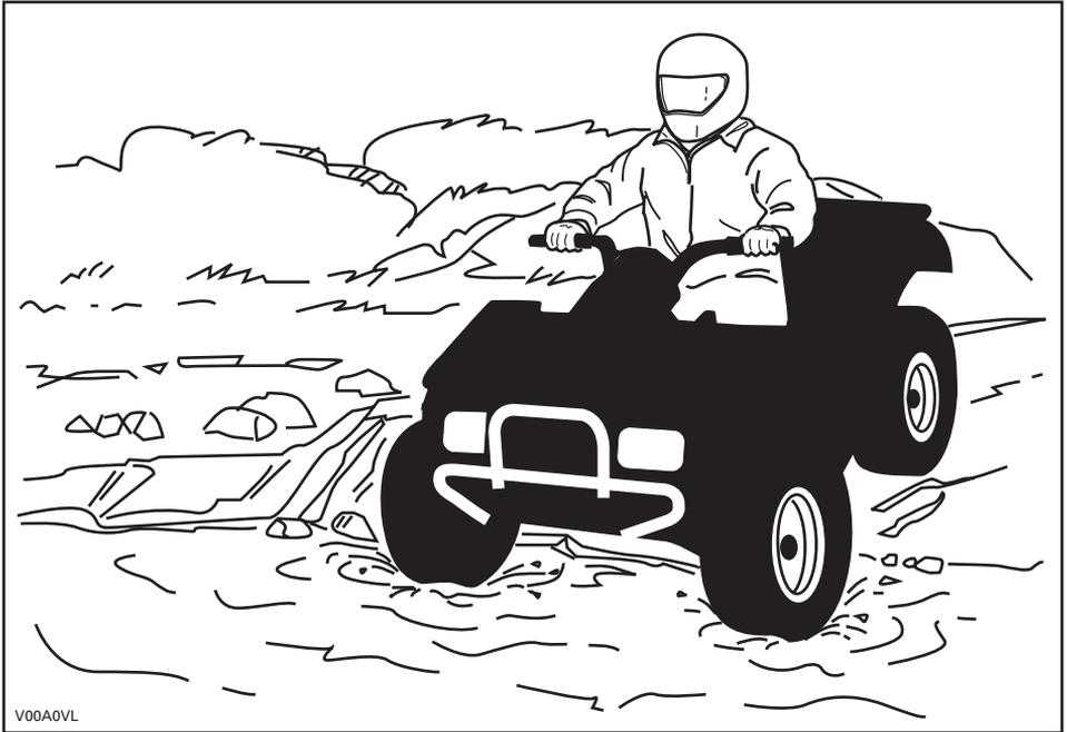
Wasser beeinträchtigt die Bremsleistung Ihres Fahrzeugs. Sorgen Sie durch mehrfaches Betätigen dafür, dass Ihre Bremsen wieder trocken werden, nachdem das Fahrzeug das Wasser verlassen hat. Mit ZWEISITZER-Modellen verändern sich möglicherweise die Bremswege, wenn Sie einen Beifahrer mitnehmen. Verringern Sie Ihre Geschwindigkeit entsprechend, wenn Sie einen Beifahrer mitnehmen. Achten Sie beim Bremsen auf einen größeren Abstand.
