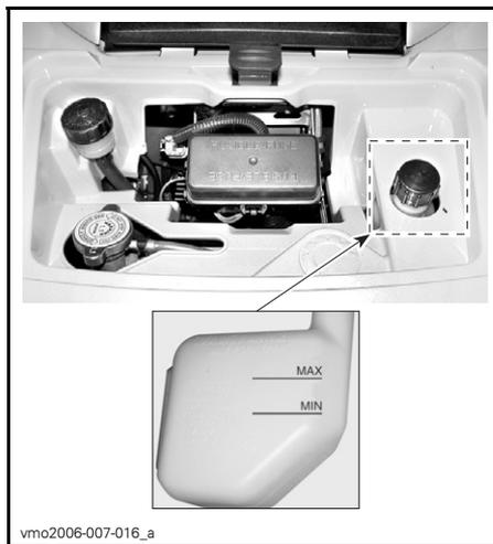
Wenn das Fahrzeug auf einer ebenen Fläche abgestellt ist, muss sich der Kühflüssigkeitsstand zwischen der MIN.- und MAX.-Markierung auf dem Kühflüssigkeitsbehälter befinden.
