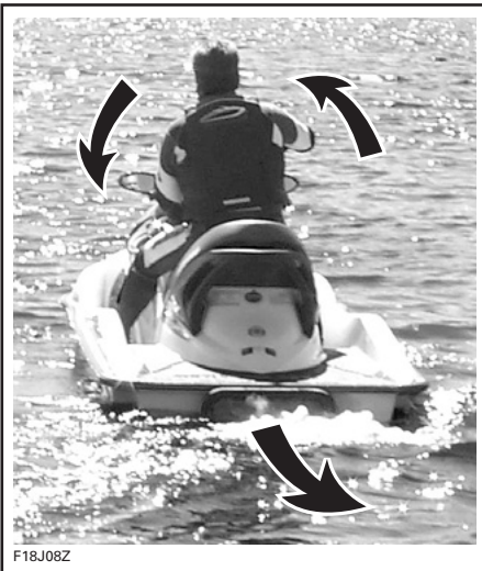
TYPISCH - LENKRICHTUNG BEIM ZURÜCKSETZEN UMGEKEHRT
