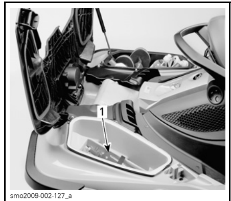
1. Lage des Feuerlöschers
