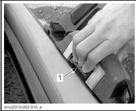
smo2010-002-010_a WAKEBOARD-HALTERUNG ABMONTIEREN 1. Zum Lösen der Wakeboard-Halterung auf diesen Griff drücken
