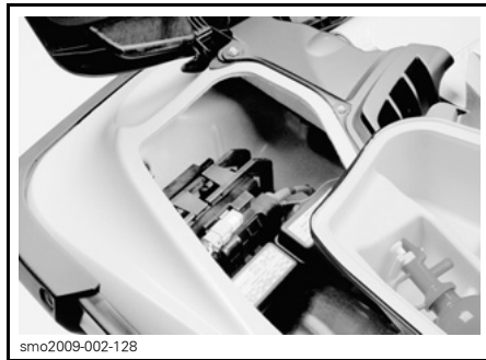
smo2009-002-128 TOEGANG TOT ACCU EN ZEKERINGEN - RECHTER OPBERGBAK VERWIJDERD
