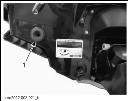
1. Emplacement du raccord de rinçage
