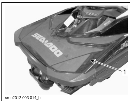
TÍPICO 1. Número de identificación del casco (H.I.N.)
