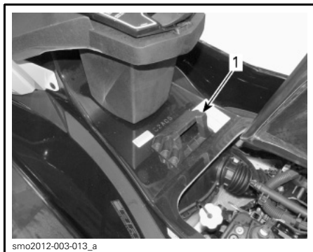
1. Dispositivo de retención delantero del asiento
