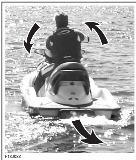
TÍPICA - DIREÇÃO INVERTIDA AO MOVER PARA TRÁS
