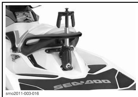
TYPIQUE - POTEAU DE FIXATION DU CÂBLE DE SKI OU PLANCHE NAUTIQUE SORTI
