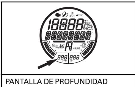
**NOTA:** La indicación de profundidad sólo está disponible si se ha instalado y detectado una sonda.
