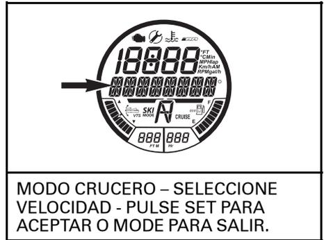
3. Pulse el botón de flecha ARRIBA hasta que la pantalla multifunción muestre la velocidad de crucero deseada.
