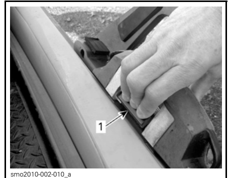
WAKEBOARD-HALTERUNG ABMONTIEREN 1. Zum Lösen der Wakeboard-Halterung auf diesen Griff drücken
