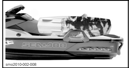
TYPISCH - BEFESTIGTES WAKEBOARD MIT NACH AUßEN ZEIGENDEN FINNEN
