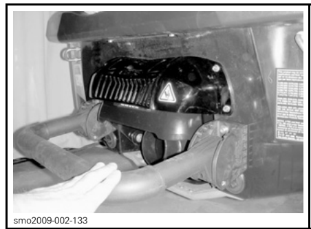
HERUNTERGEKLAHPTER AUFSTIEGTRITT ZUM BESTEIGEN AUS DEM WASSER HERAUS
