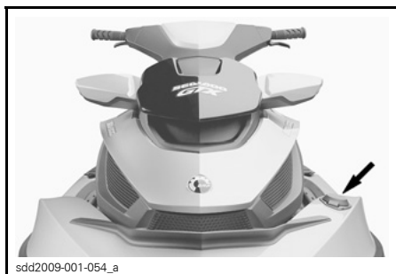
TYPISCH - PLAATS VAN DE BRANDSTOFTANKDOP
