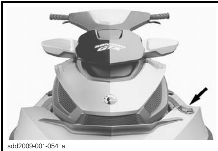
TIPIQUE - EMBLACEMENT DU BOUCHON DU RÉSERVOIR D'ESSENCE
