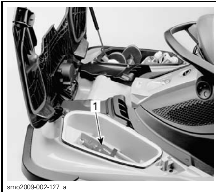
1. Emplacement du support d'extincteur
