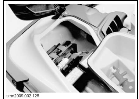
ZUGRIFF AUF BATTERIE UND SICHERUNG - RECHTER VERSTAUBEHÄLTER ENTFERNT
