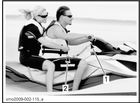
TYPISCH 1. Haltegurtkappe am Motorausshalter 2. Haltegurt an Rettungsschwimmkörper des Fahrers befestigt
