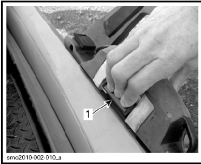
尾波板架拆卸
