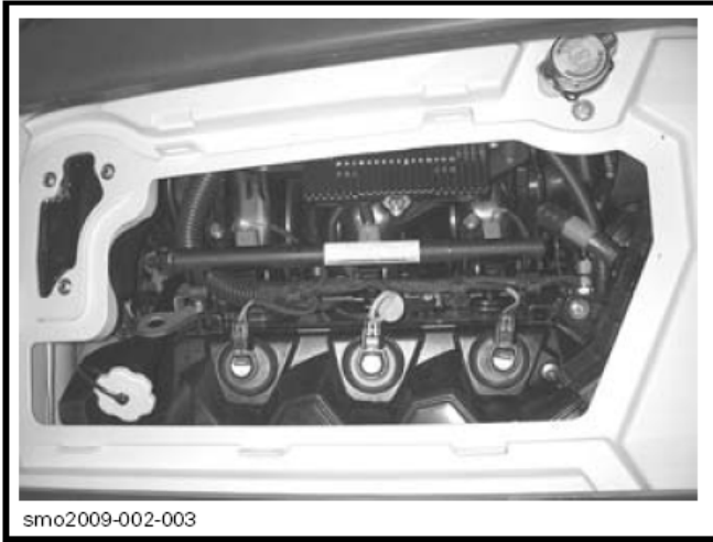
通气箱拆除后
