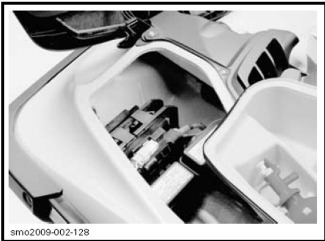
右边储物箱拆除 - 电池和保险丝通道
