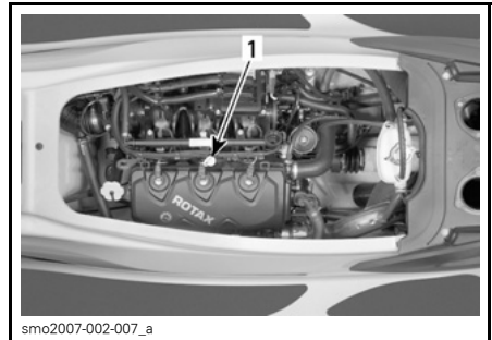
smo2007-002-007_a MODELOS SIN TAPA DE MOTOR 1. Varilla de medición del nivel de aceite
