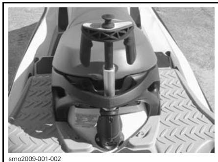
smo2009-001-002 POTEAU DE FIXATION DU CÂBLE DE SKI OU PLANCHE NAUTIQUE SORTI
