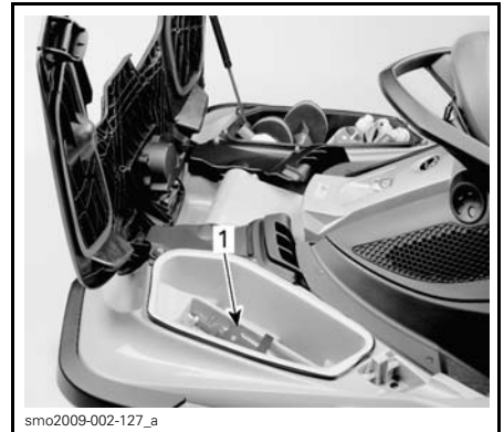
1. Emplacement du support d'extincteur
