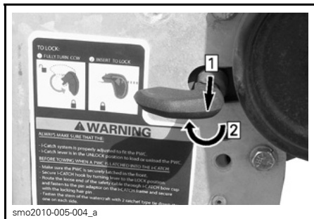
smo2010-005-004_a Stap 1: Hendel uittrekken Stap 2: Rechtsom draaien
