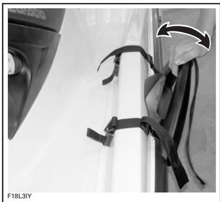
注: ウエイクボードをラックから外しているときは、バンジーコードを固定して、ウォータークラフトの航行中にコードが動き回らないようにしてください。
