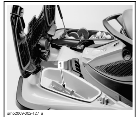
1. Extintor de incêndio
