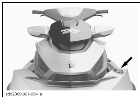
TÍPICO - TAMPA DO TANQUE DE COMBUSTÍVEL
