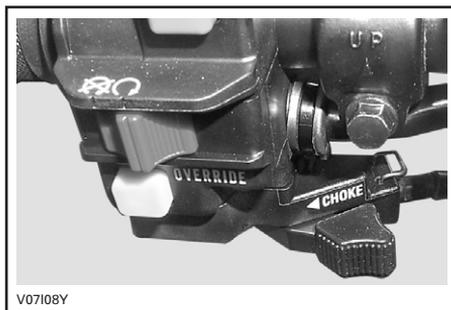
**PALANCA DEL ESTRANGULADOR EN LA POSICIÓN DE CIERRE**
