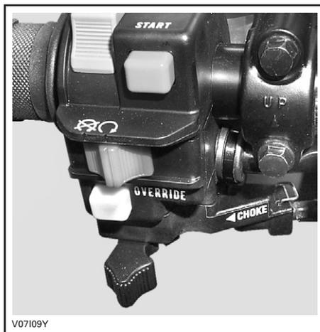
**PALANCA DEL ESTRANGULADOR EN LA POSICIÓN DE APERTURA**
