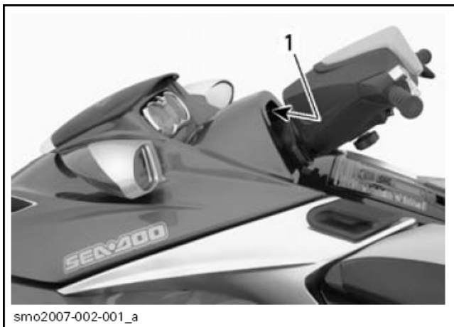
典型图示 - 所有型号，GTI 型号除外 1. 锁杆
