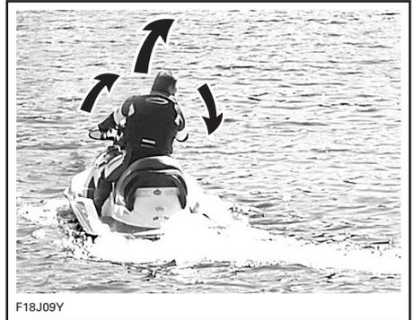
Durch Drehen des Lenkers wird die Strahlpumpendüse geschwenkt, wodurch wiederum die Fahrtrichtung bestimmt wird. Durch Drehen des Lenkers nach rechts schwenkt auch das Fahrzeug nach rechts und umgekehrt. Der Gashebel muss betätigt werden, um das Fahrzeug zu drehen.
