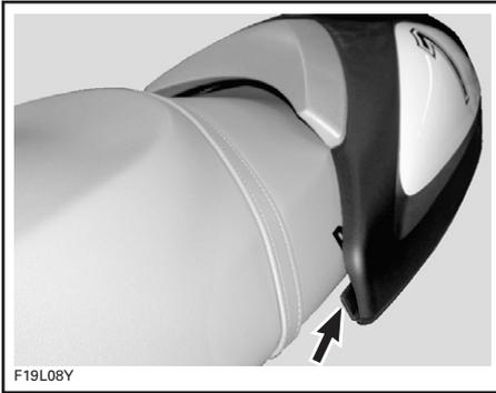
Beenden Sie das Einschieben der Abdeckung und verriegeln dann die Bajonettschlüsse.
