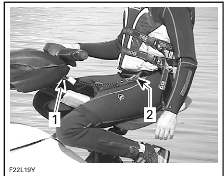
1. Nödstoppslinan monterad på plats 2. Nödstoppslinan säkert fäst i förarens flytväst
