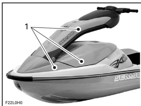
1. Carenatura del motore, parti frontali e superiori del piantone di guida
