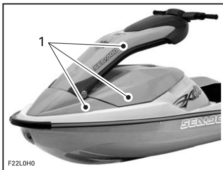
1. Couvercle du compartiment moteur, bout et pièce supérieure de la colonne de direction
