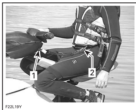
1. Capuchon sur la borne du cordon de sécurité 2. Cordon de sécurité fixé au VFI du conducteur
