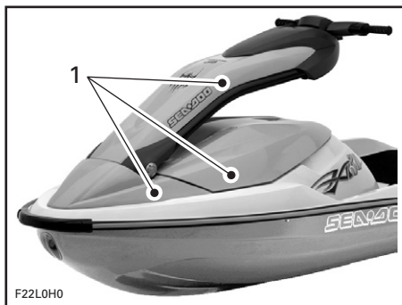
1. Moottorikoppa, ohjauspylvään pää ja päällysosat
