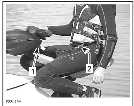
1. Turvanaruliittimen tulppa pitimessään 2. Turvanaruliitin kiinni kuljettajan henkilökohtaisessa kelluntavälineessä
