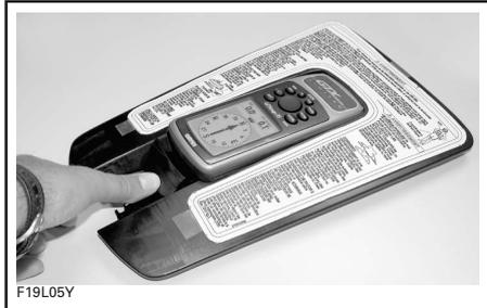
Zum Wiederaufbau positionieren Sie den GPS-Empfänger in seine Aufnahme und drücken ihn, bis er einrastet.
