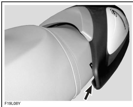
Beenden Sie das Einschieben der Abdeckung und verriegeln Sie dann die Bajonettverschlüsse.
