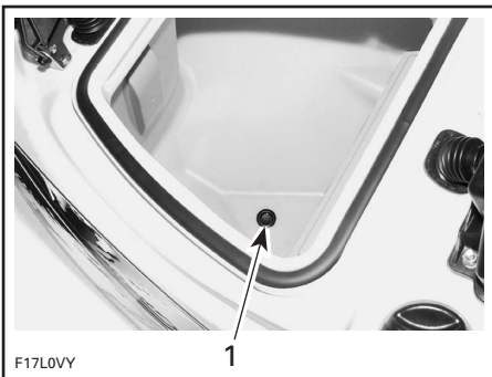
1. Tapón de drenaje
