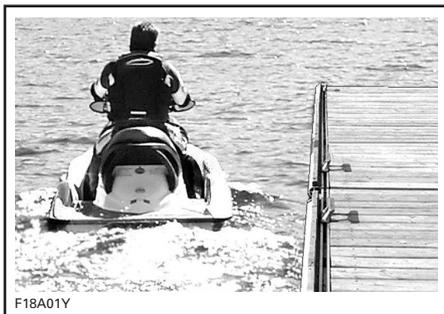
Steigen Sie in seichtem Wasser von der Seite oder von hinten auf das Fahrzeug auf. Kontrollieren Sie, dass mindestens 90 cm Wasser unter dem tiefsten hinteren Teil des Rumpfes ist.
