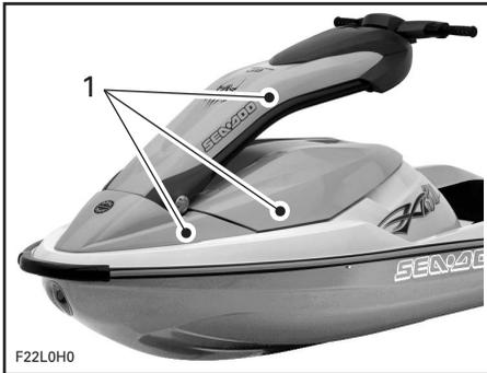
1. *Carenatura del motore, parti frontali e superiori del piantone di guida*
