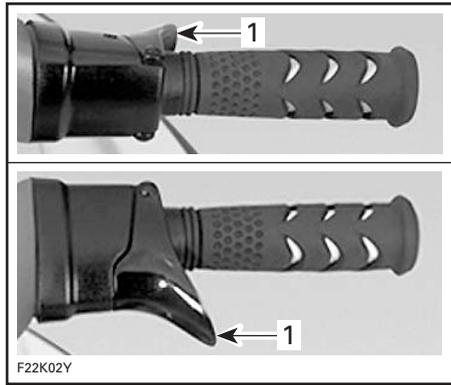
1. Palanca del acelerador
