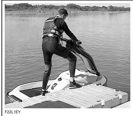
**NOTA:** Al abordar una embarcación que tenga la configuración de asiento de "moto" o de "kart", usted puede usar el asiento como un punto de apoyo adicional para mantener el equilibrio.
