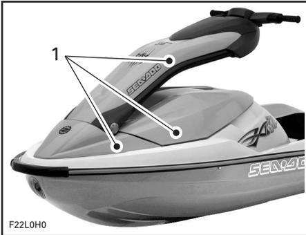
1. Tapa del motor, punta y piezas superiores de la columna de dirección
