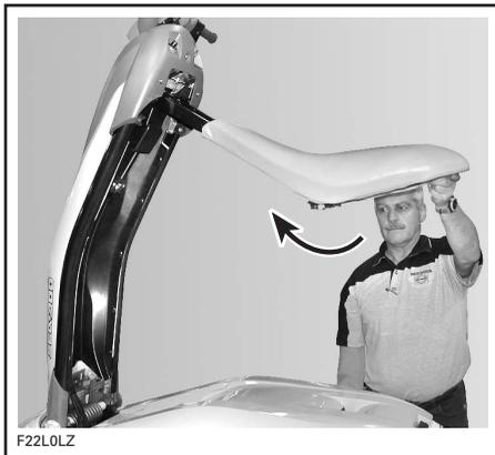
**PRECAUCIÓN:** Asegúrese de mantener la columna de dirección a la altura suficiente para que el asiento de "moto" pase limpiamente sobre la tapa del motor al hacer girar el asiento hacia delante y meterlo en la columna.
