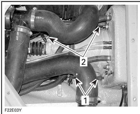
1. *Apriete la manguera de drenaje de los cilindros del motor*
