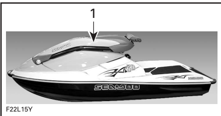
1. Lenksäule hier nach unten verspannen
