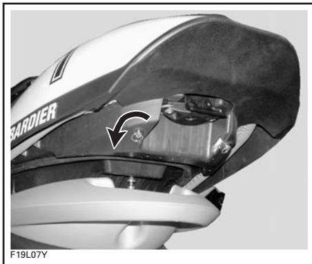
Tirer sur les languettes de chaque côté du siège, puis retirer le couvre-siège.
