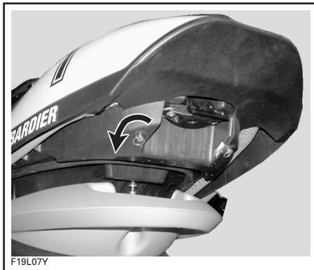
Tire de las pestañas de la cubierta, situadas a ambos lados del asiento, y saque luego la cubierta.
