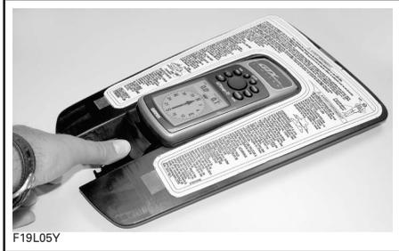
Para volver a instalarlo, coloque el receptor GPS en su receptáculo y presione hasta que quede enganchado.
