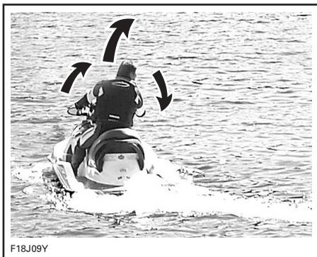
Al girar el manillar, pivota la tobera de la bomba de impulsión que controla la dirección de la embarcación. Girando el manillar hacia la derecha, la embarcación girará hacia la derecha y a la inversa. Debe aplicarse aceleración para girar la embarcación.
