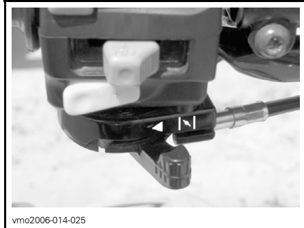
TÍPICO — ALAVANCA DO AFOGADOR NA POSIÇÃO OFF
