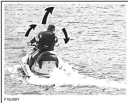
Girando il manubrio, l'iniettore della pompa a getto che controlla la direzione dell'imbarcazione gira su sé stesso. Girando il manubrio a destra, l'imbarcazione sterza a destra e viceversa. Per girare l'imbarcazione, accelerare.
