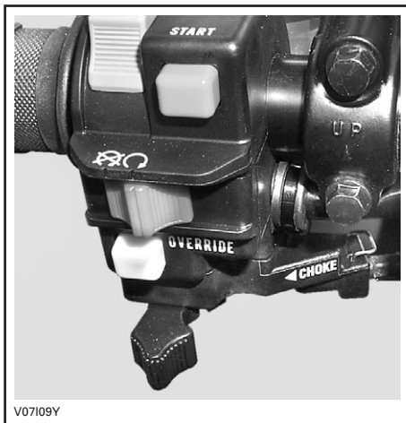
ALAVANCA DO AFOGADOR NA POSIÇÃO TOTALMENTE ABERTO
