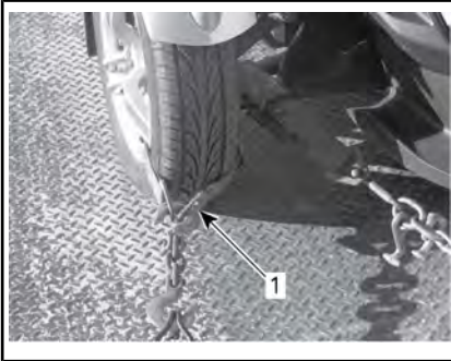
BEVESTIGING VAN DE VOORWIELEN — STANDAARD
