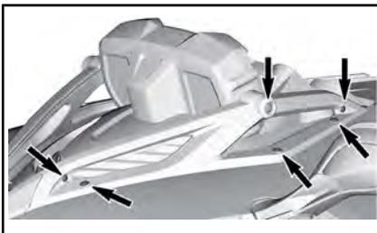
2. アイレットを車両に固定している取り付けスクリーンを取り外します。
