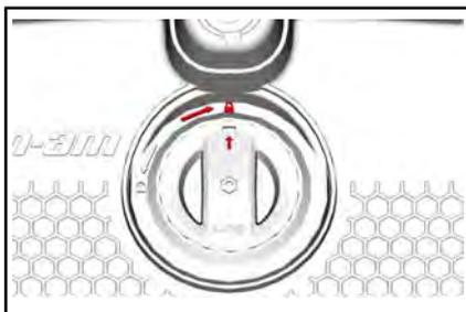
6. ストレージコンパートメントをしっかりとつかみ、車両に正しく取り付けられ、ロックされているか確認します。
