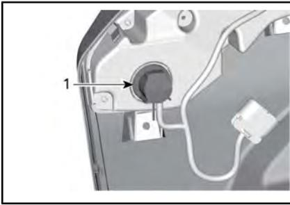
1. バルブホルダーを時計方向に回して外します。
