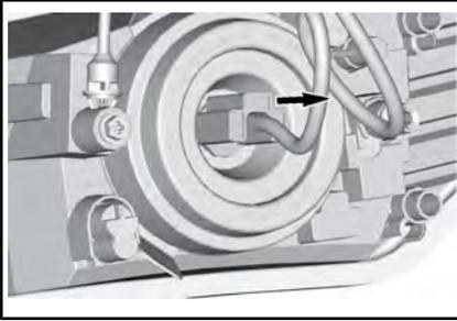
10. ラバーハウジングキャップを引き抜きます。
