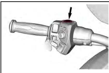
リバースにシフトするためにリバースボタンを押し続けます。詳細は、基本手順のサブセクションの後進走行を参照してください。
