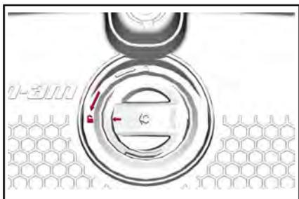
3. 後部のハンドルを使用して、車両から上部ストレージコンパートメントのラッチを解除します。
