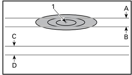
代表例- 試験面上へのヘッドライトの反射—ハイビーム（片方のヘッドランプ）
