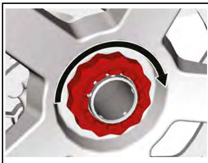
1. Ingeklapte uiteinde moet naar de aandrijf-as wijzen
