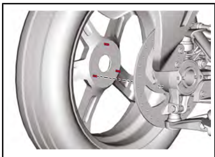
1. Ingeklapte uiteinde moet naar de aandrijf-as wijzen
