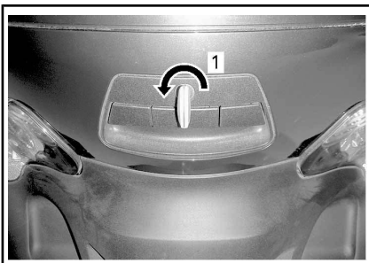
1. Linksom draaien om te ontgrendelen.
